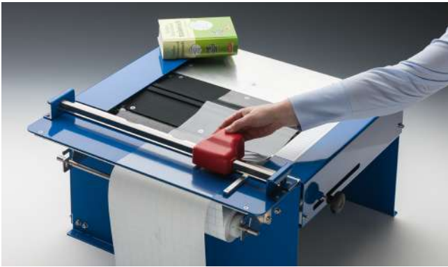
7. A présent découper le film à l'aide de la tête de coupe.
